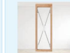
小さな揺れでは耐力壁として建物へのダメージを軽減し、大きな揺れでは金属の靱性を活かしたデバイスが、制振壁として振動エネルギーを吸収する木造軸組工法の耐震・制震壁です。壁倍率は4.8倍であるため、少ない壁に設置するだけでも大きな耐力を得ることができ、コストパフォーマンスに優れています。
